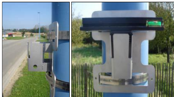
Figures 5 et 6. Le support doit être parallèle et horizontal par rapport à l'axe de la rue
