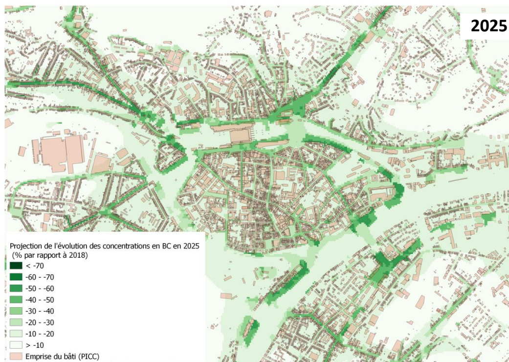
Figure 72 – Evolution des concentrations en BC à Namur projetée pour 2025 par le modèle ATMO-Street.
