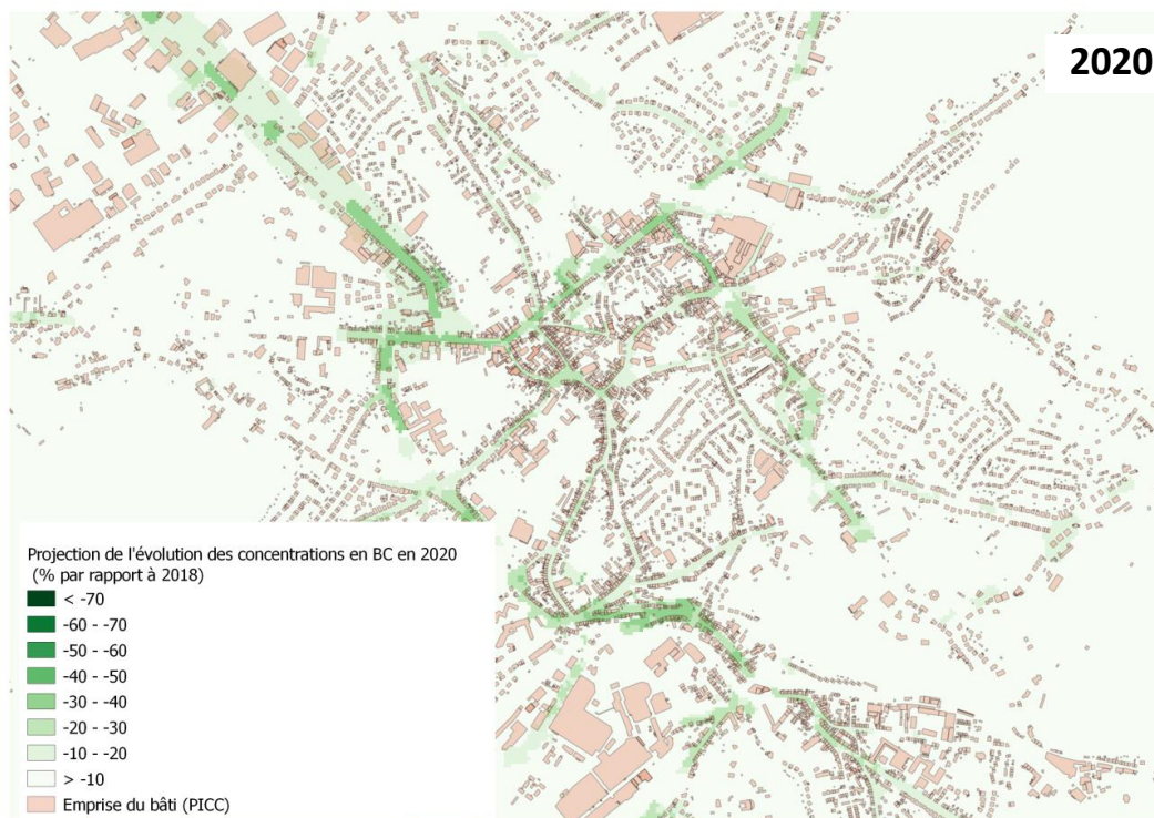
Figure 64 – Evolution des concentrations en BC à Eupen projetée pour 2020 par le modèle ATMO-Street.
